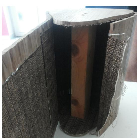
Il manico è stato ricavato dall'assemblaggio di listelli con successivo smussamento degli angoli in modo da rendere la struttura più armoniosa. Lo stesso è stato applicato al bauletto mediante due fori all'estremità e assemblato ai profili con viti e rondelle. Infine è stata applicata una calamita al centro della patta fissa e una all'interno della patta mobile in modo da determinare la chiusura e apertura della borsa.
