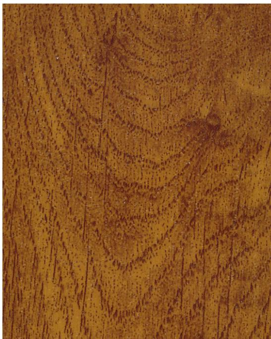
Fig. 21: "Slumacature" date dai raggi in sezione di legno di Quercia.
