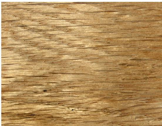
Fig. 25: Fibratura irregolare del legno di Quercia.
