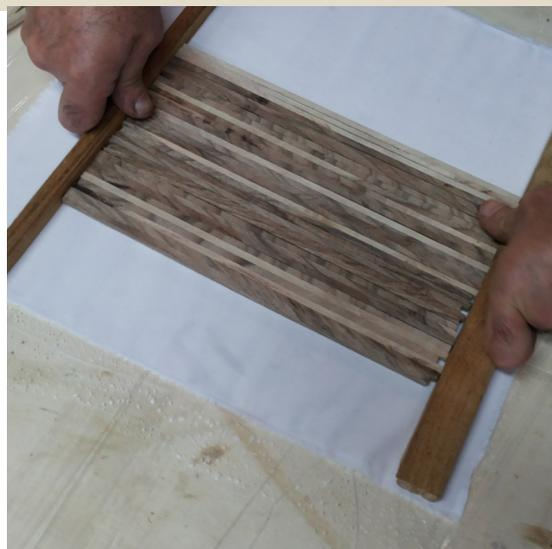
Aiutandoci con delle tavolette più grandi abbiamo fatto pressione sui lati dei listelli per renderli omogenei, e le abbiamo fissate con delle viti. Sulla struttura abbiamo poi posizionato delle tavole e delle zeppe per comprimere il tutto.
