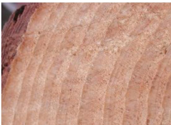
Fig. 13: Anelli di incremento in una sezione trasversale di Castagno.
