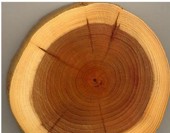
Fig. 18: Sezione di un ramo di tasso con ben evidenziati l'alburno e il durame.
